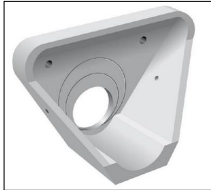
Figure 15 : Ouvrage de protection du rejet au Drac – Source : ALP'ETUDES, novembre 2022
